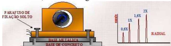
Figura 6 – Má fixação da base do acionamento. Fonte: VE Engenharia (2015)
