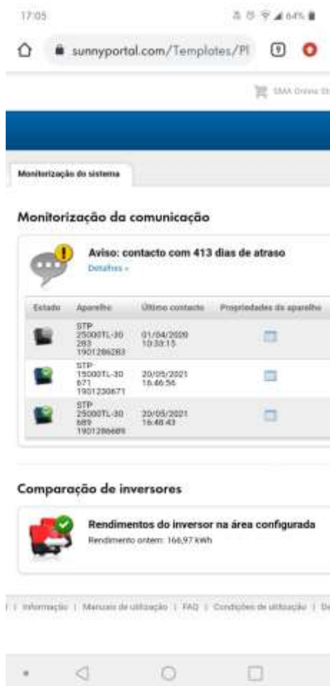
Figura 7 – Constatação do problema de monitorização da comunicação com um dos inversores de 25kW.
