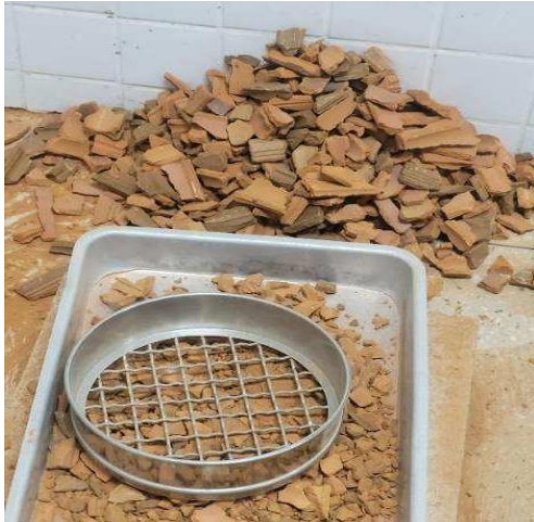
Figura 7: peneiramento na malha 19mm.
