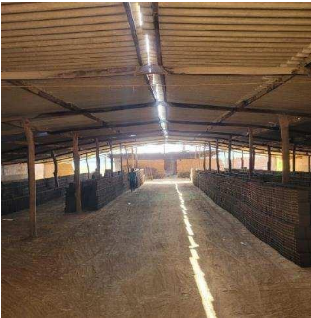
Figura 6: Etapa de secagem após a queima dos tijolos na olaria das Melancias.
