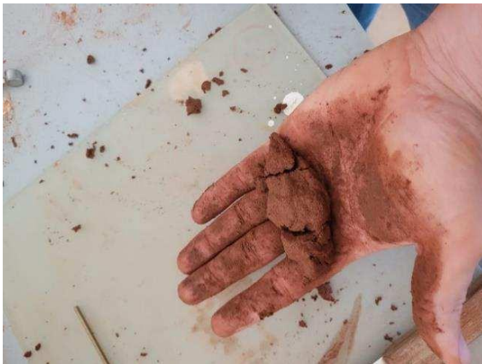
Figura 24: amostra com fissuras após tentativas.
