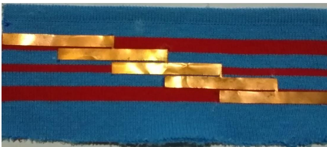
Figura 36 – Protótipo Do Filtro Rejeita – Banda Construído Sobre O Substrato Têxtil
