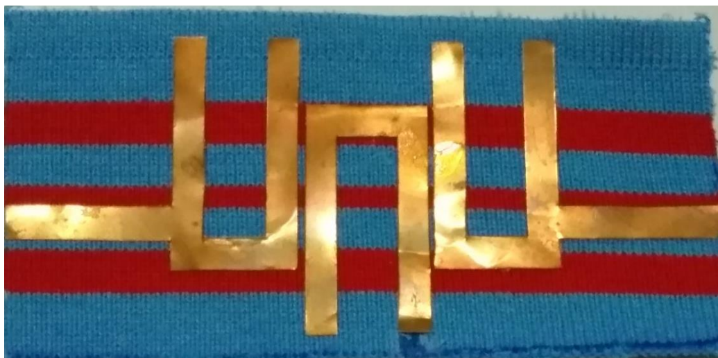
Figura 28 – Filtro Planar Construído
