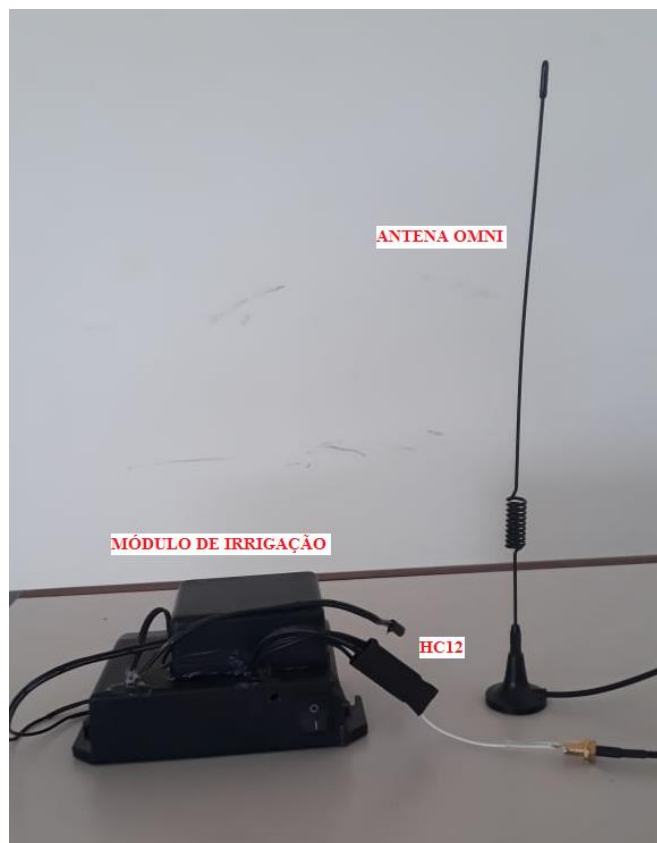
Fig. 12. Módulo de irrigação com antena omni. (Autoria própria)
