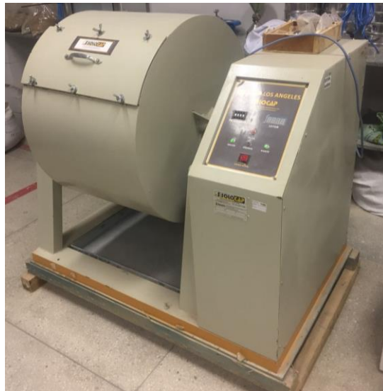
Figura 04: Equipamento de abrasão Los Angeles.
