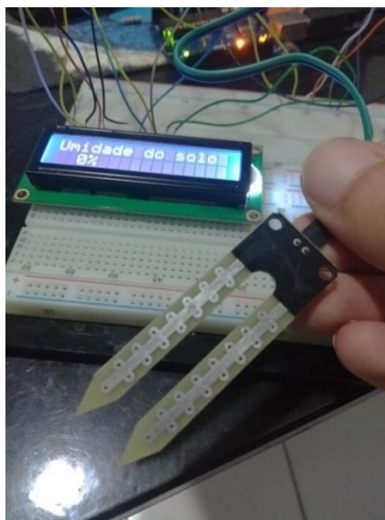
Figura 3.2 – Teste do sensor em contato com o ar.
