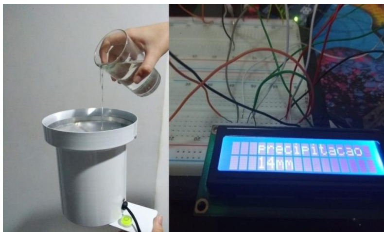
Figura 3.3 – Teste do Pluviômetro. Fonte - Autoria Própria 2019
