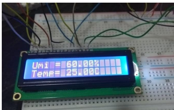
Figura 3.5 - Teste do DHT11
