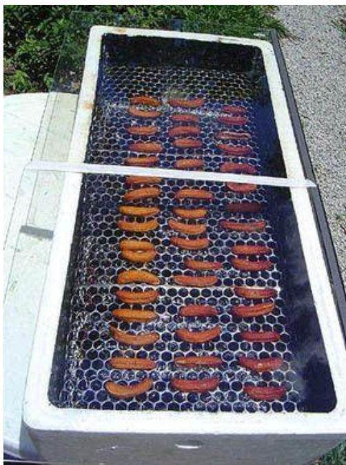
Figura 3. Exemplo de secador solar de convecção natural (direta). (GOOGLE)
