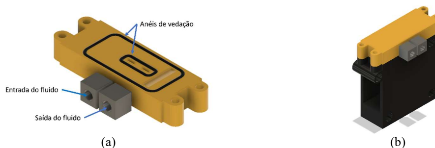
FIGURA 8. Modelos 3D da célula de fluxo. (a) Visão geral do modelo e seus elementos constitutivos. Com destaque a entrada e saída do fluido através de entradas laterais; (b) Conjunto célula de fluxo e case do sensor (autoria própria).
