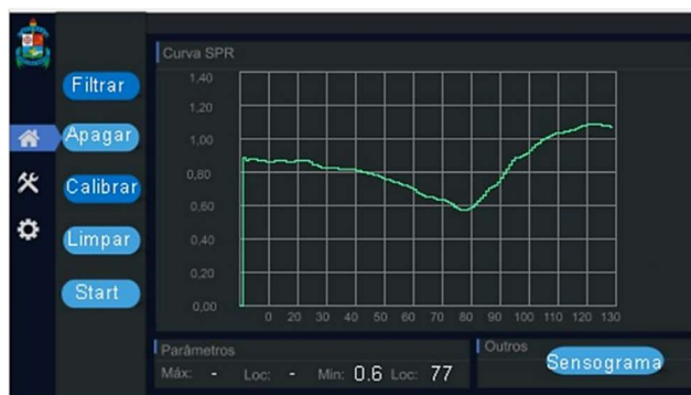
FIGURA 20. Curva SPR da amostra de hipoclorito de sódio. Mínimo indicado na posição de pixel 77 (autoria própria).
