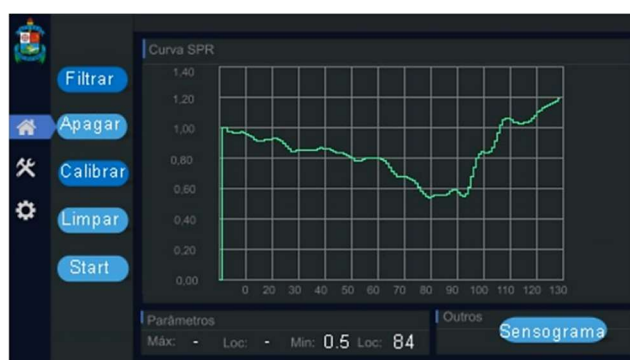
FIGURA 19. Curva SPR da amostra de água deionizada. Mínimo indicado na posição de pixel 84 (autoria própria).
