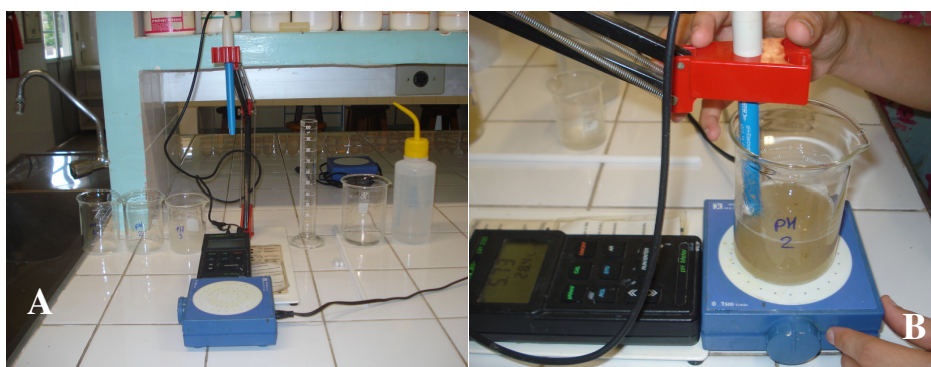
Figura 20. Peagâmetro e vidraria utilizada nas leituras (A) e fazendo a leitura de pH e temperatura na solução (B)
