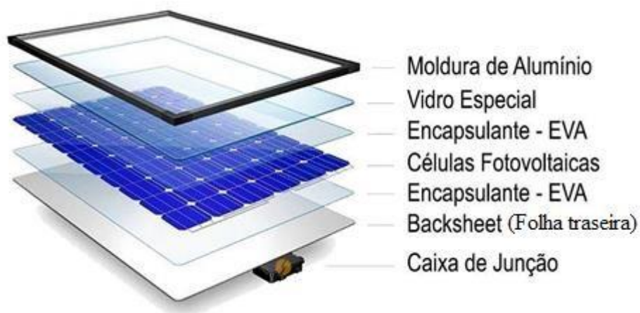
Figura 2.6 - Componentes das camadas de um módulo de silício cristalino.
