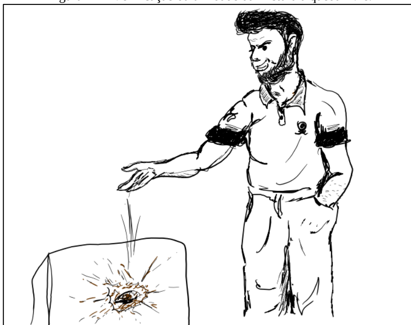
Figura 11 – Verificação da umidade da mistura a queda livre.
