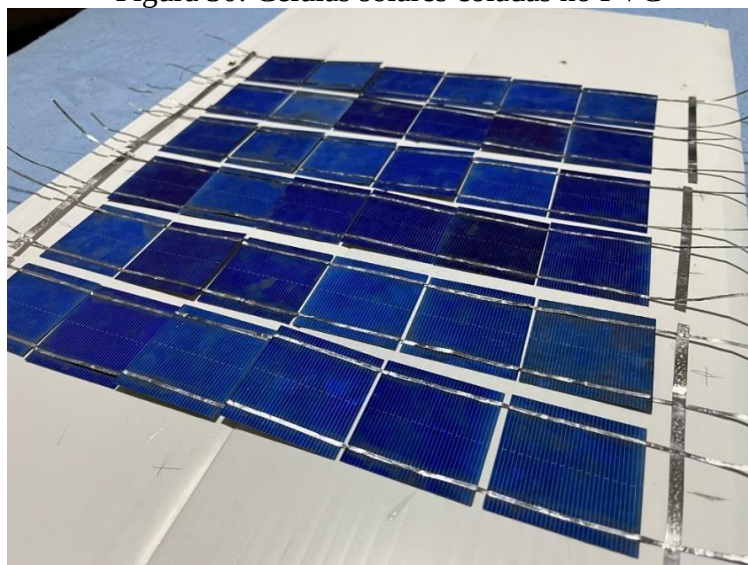
Figura 30: Células solares coladas no PVC
