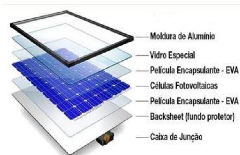
Figura 15: Composição do Módulo Fotovoltaico
