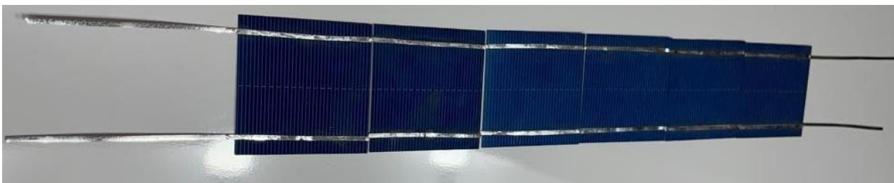
Figura 28: conexão entre as células solares parte negativa
