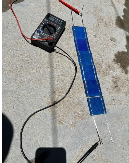
Figura 36: Testes em cada linha de células
