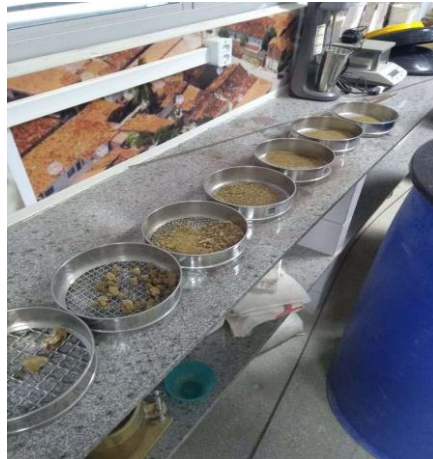
Figura 5 – Peneiramento da amostra antes do processo de compactação
