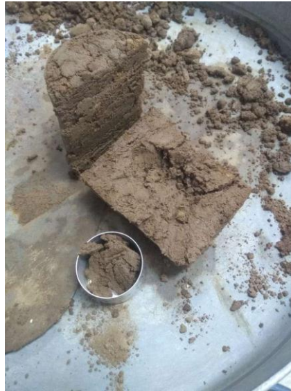
Figura 6 – Retirada da amostra úmida do solo compactado
