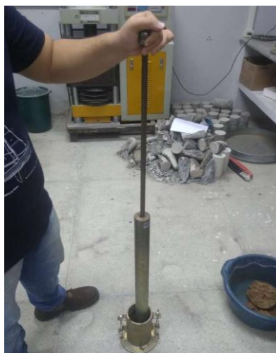
Figura 7 – Aplicação da energia de compactação durante o ensaio
