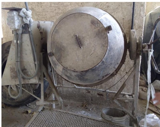
Figura 9: Betoneira com tampa.
