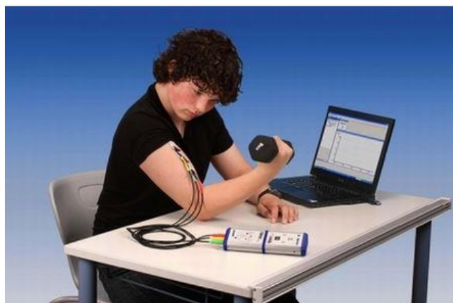
Figura 9. Exemplo de eletromiograma (EMG), sendo usado para estudo das forças musculares.
