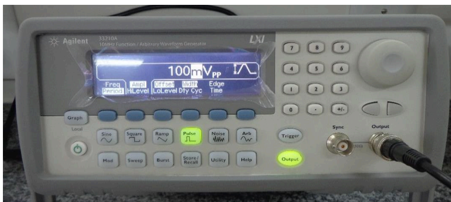
Figura 32. Gerador de Funções responsável por gerar o sinal de 100mV.
