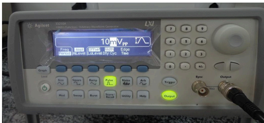
Figura 31. Gerador de Funções, responsável por gerar o sinal de 10 mV.
