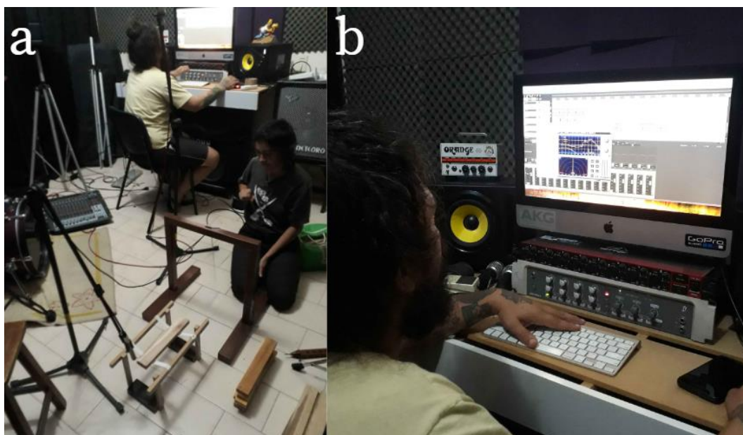
Figura 12 – Lançamento do pêndulo em sarrafo de madeira (a) e registro da gravação (b) em sala anecóica.
