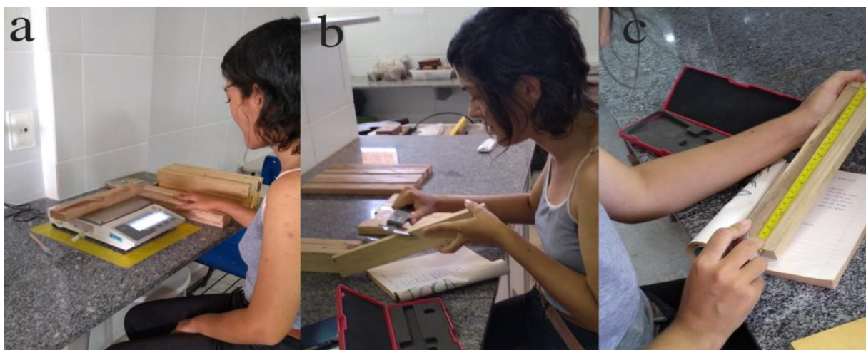
Figura 8 - (a) Pesagem, (b) e (c) medição das dimensões dos corpos de prova das madeiras de Aspidosperma pyrifolium Mart. & Zucc (Pereiro), Auxemma oncocalix (Allemão) Taub. (Pau-branco) e Eucalyptus urograndis (Eucalipto).
