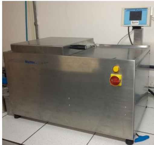
Figura 66. Equipamento utilizado para o ensaio de estabilidade dimensional (Mathis WT).
