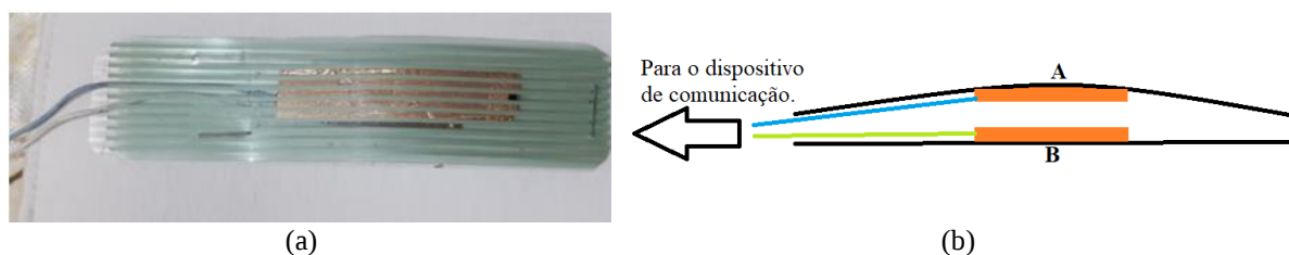
Figura 83. Sensor de compressão (a) sensor desenvolvido (visão superior) (b) Ilustração da estrutura interna (visão lateral).
