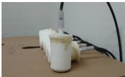
Figura 6. Modelo de mangueira adicionada ao conjunto para manter o sistema de pressurização em funcionamento.
