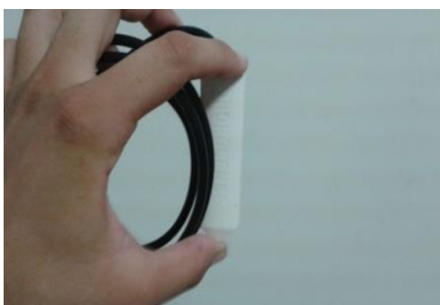
Figura 7. Modelo de Sensor Irrigás® usado para comparação com os filtros comerciais.
