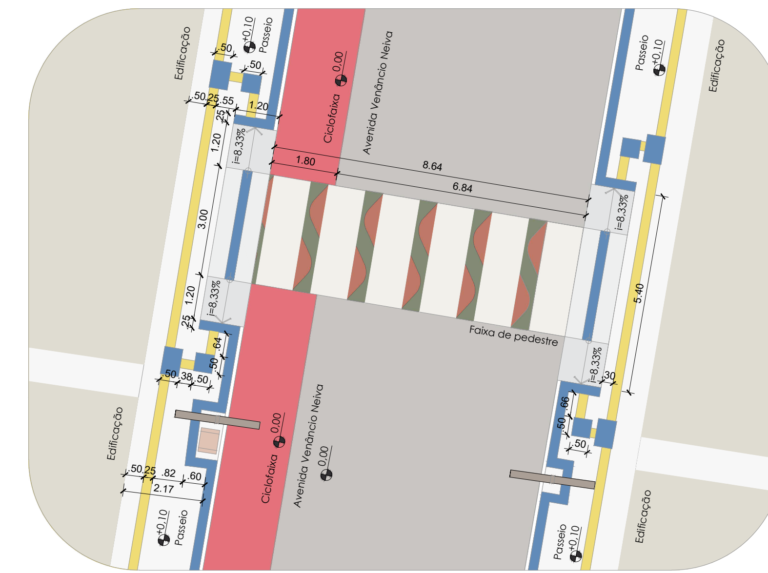
Detalhamento 03 - Rampas e passeio escala: 1:100
