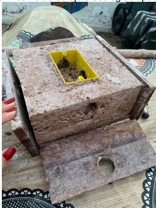
Figura 4.8. Desmolde do tijolo ecológico após secagem.
