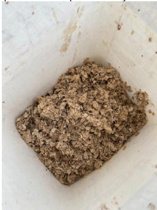
Figura 4.3. Papelão triturado para fabricação de tijolo ecológico.
