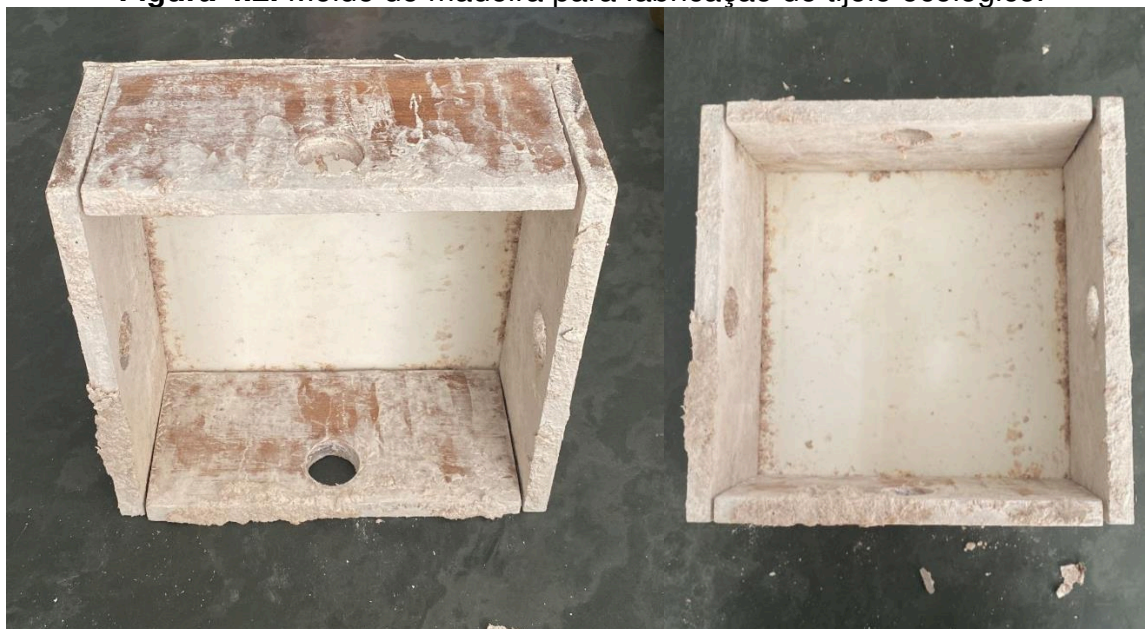
Figura 4.2. Molde de madeira para fabricação de tijolo ecológico.
