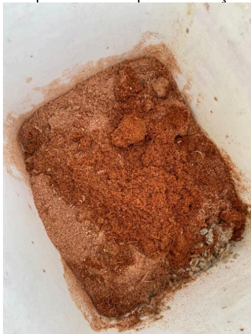
Figura 4.4. Adição de pó de serraria para fabricação de tijolo ecológico.
