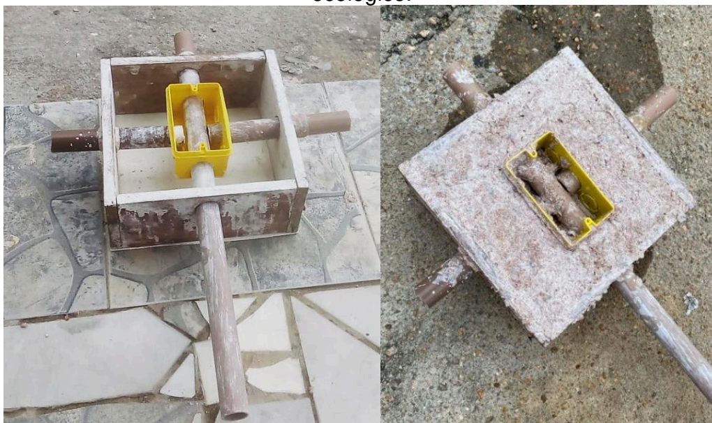
Figura 4.7. Inserção da mistura dos ingredientes no molde para fabricação de tijolo ecológico.
