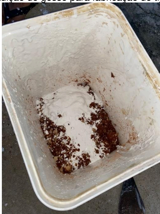
Figura 4.6. Adição de gesso para fabricação de tijolo ecológico.
