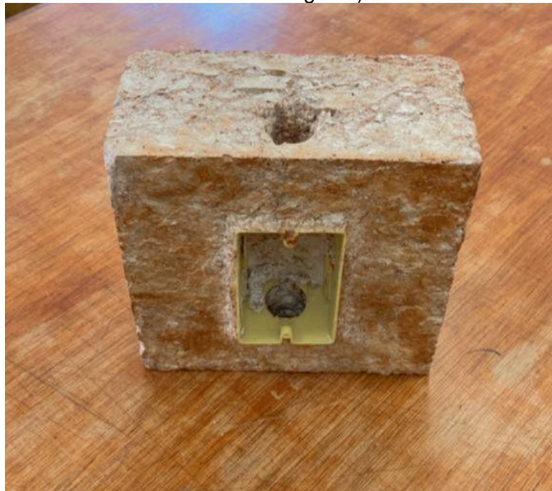
Figura 4.10. Tijolo ecológico pronto para teste de resistência à compressão (visto em dois ângulos).
