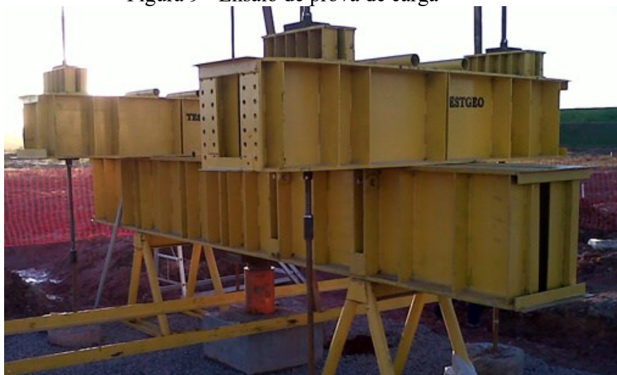
Figura 9 - Ensaio de prova de carga
