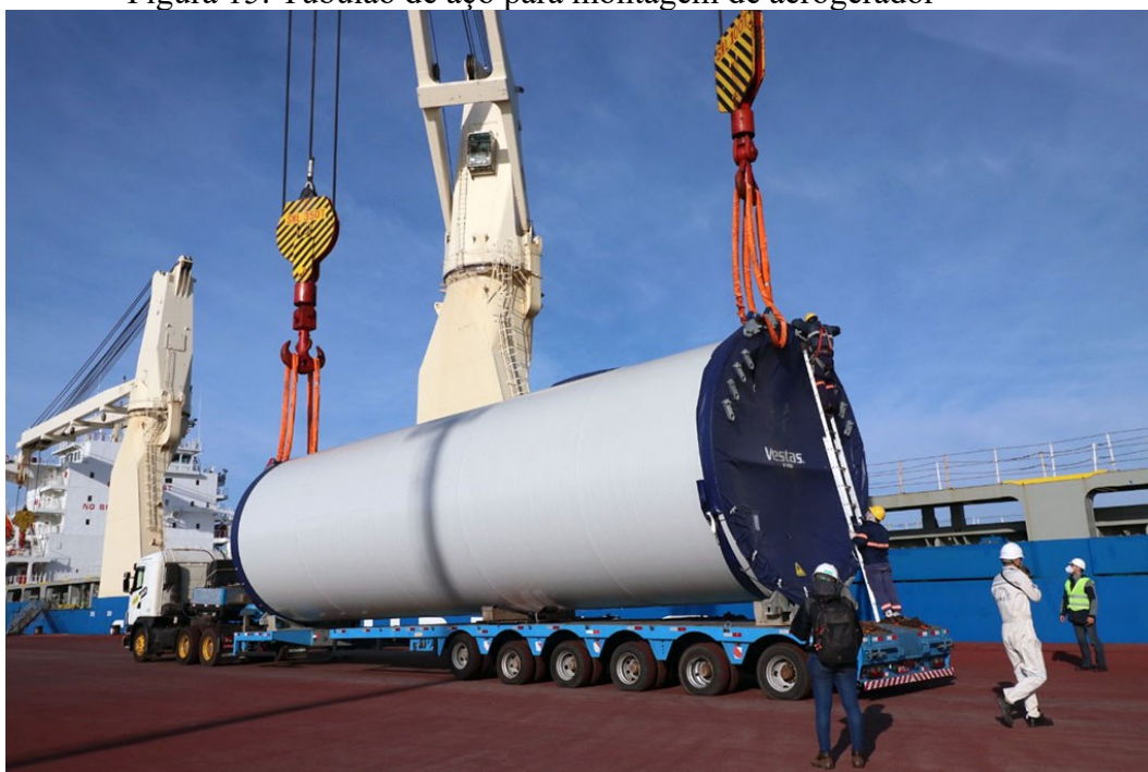
Figura 15: Tubulão de aço para montagem de aerogerador
