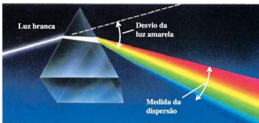
Figura 6: Dispersão da luz em um prisma
