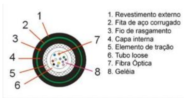
Figura 38 – Cabo tipo Loose tube buffer .
