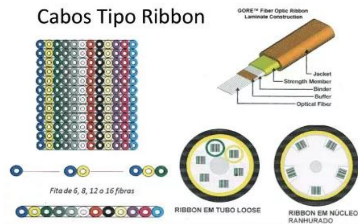
Figura 41 – Cabo tipo Ribbon .
