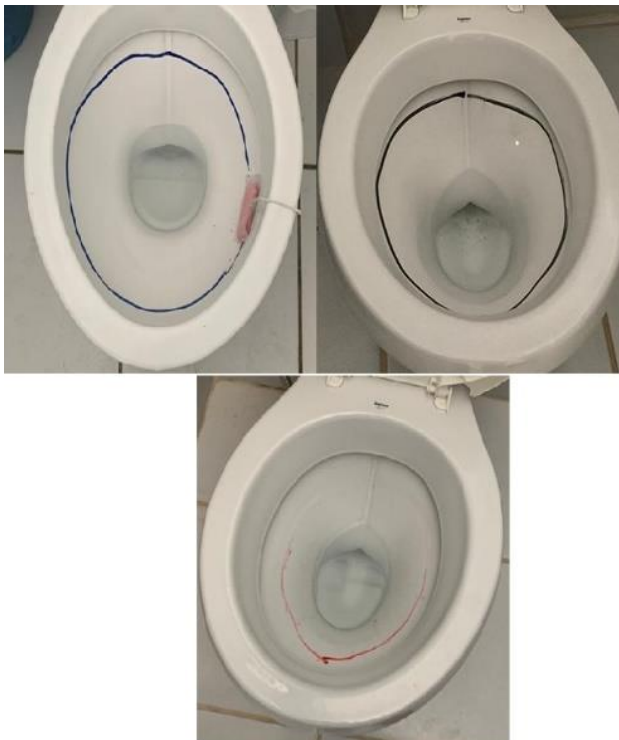
Figura 17 – Teste da caneta hidrossolúvel em bacias sanitárias
