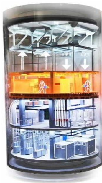
Figura 4 - Modelo de uma fábrica da Intel distribuído entre níveis
