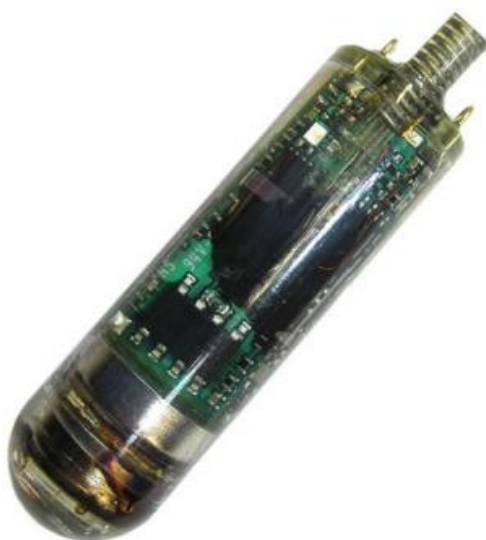
Figura 2. Marca eletrônica LOTEK utilizada para as medições de temperatura e pressão.
