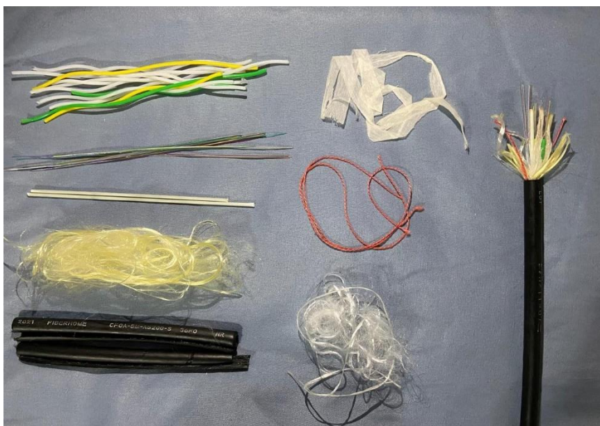
Figura 3.5: Separação dos componentes dos cabos, neste caso o cabo de 36 fibras
