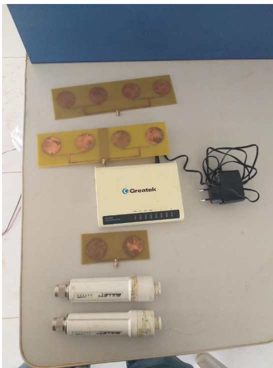
Figura 72- Equipamentos utilizados para enlace de rádio
