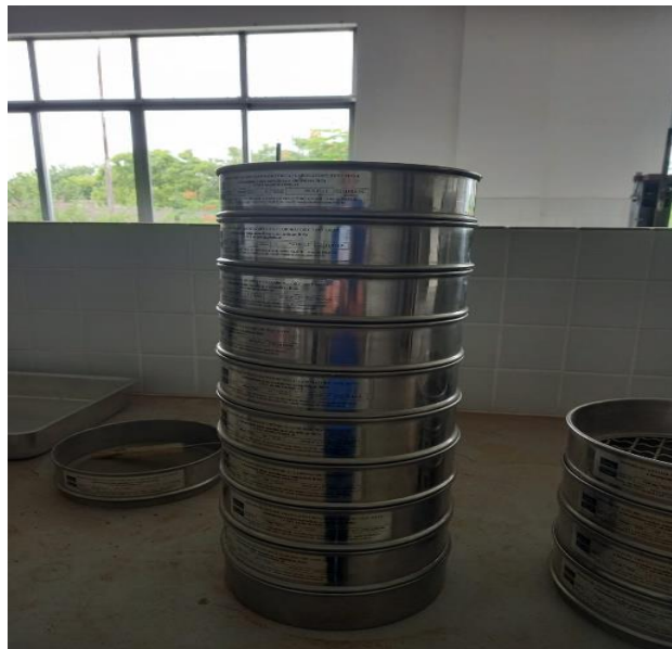
Figura 12 – Peneiramento do Solo Laterítico
