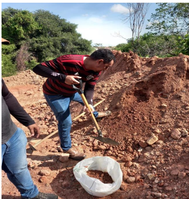
Figura 06 – Coleta da amostra de solo laterítico.
