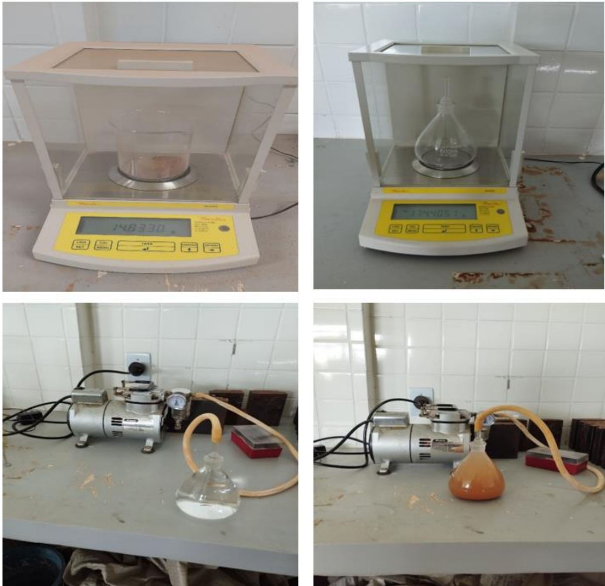
Figura 09 – Ensaio para determinação de Massa específica do solo laterítico
