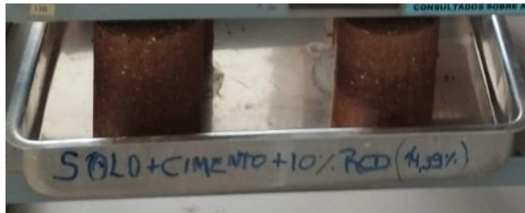
Figura 16 - Misturas de solo/cimento/10%RCD
