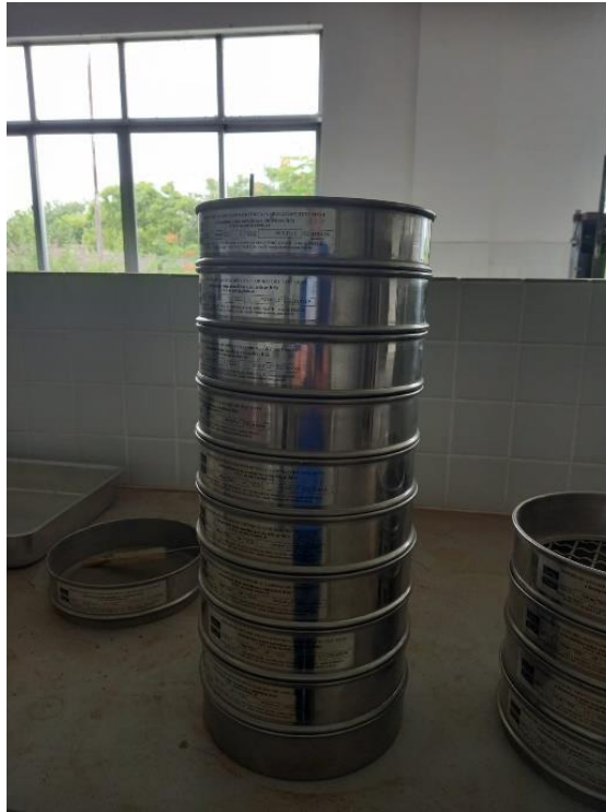
Figura 7 – Peneiramento do Solo Laterítico
