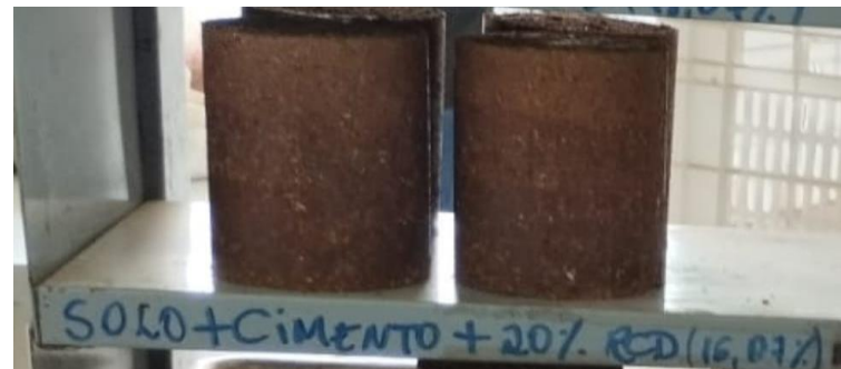
Figura 17 - Misturas de solo/cimento/20%RCD
