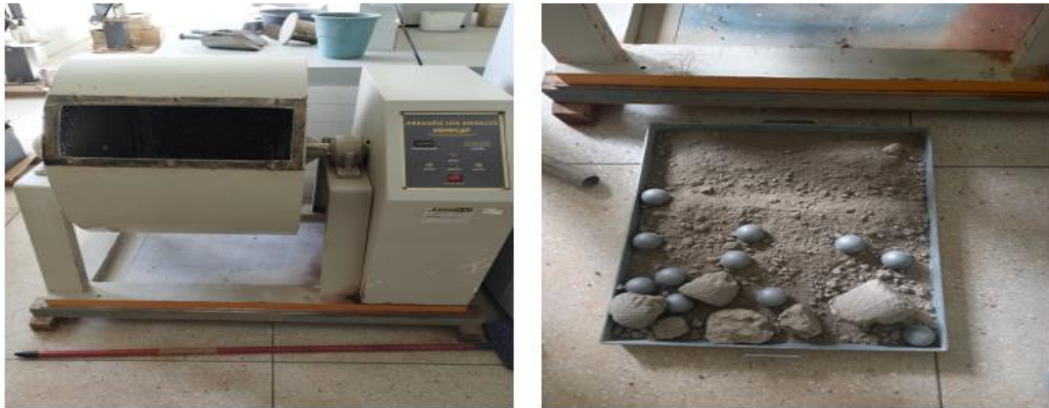
Figura 11 – Geração do RCD com o equipamento de Abrasão Los Angeles
