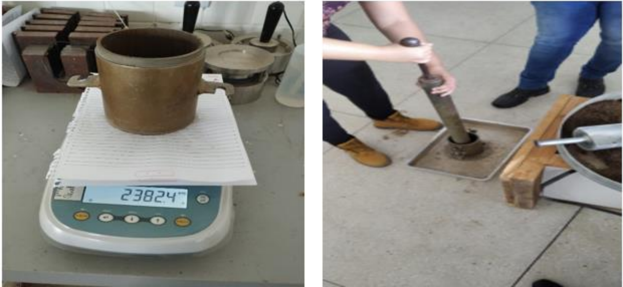
Figura 13 – Equipamentos utilizados no ensaio de Compressão Simples
