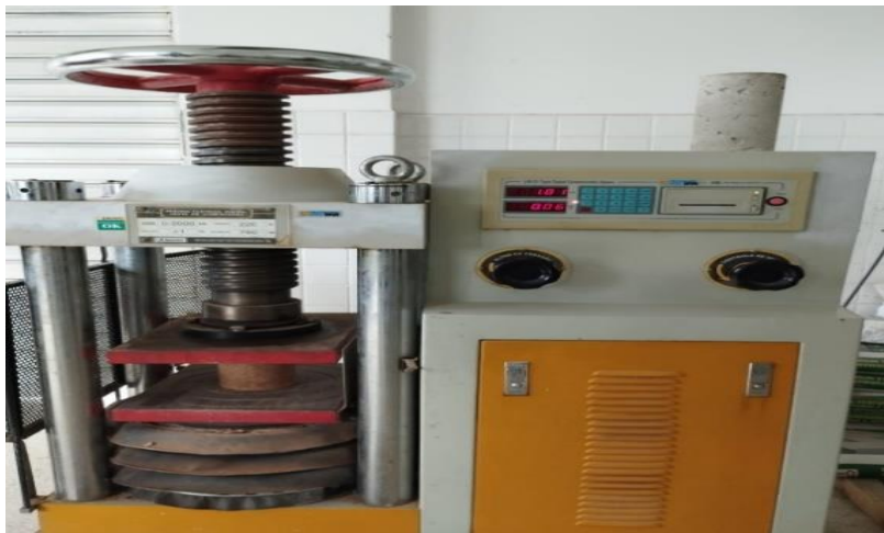
Figura 19 – Prensa Elétrica Digital para Teste de Compressão
