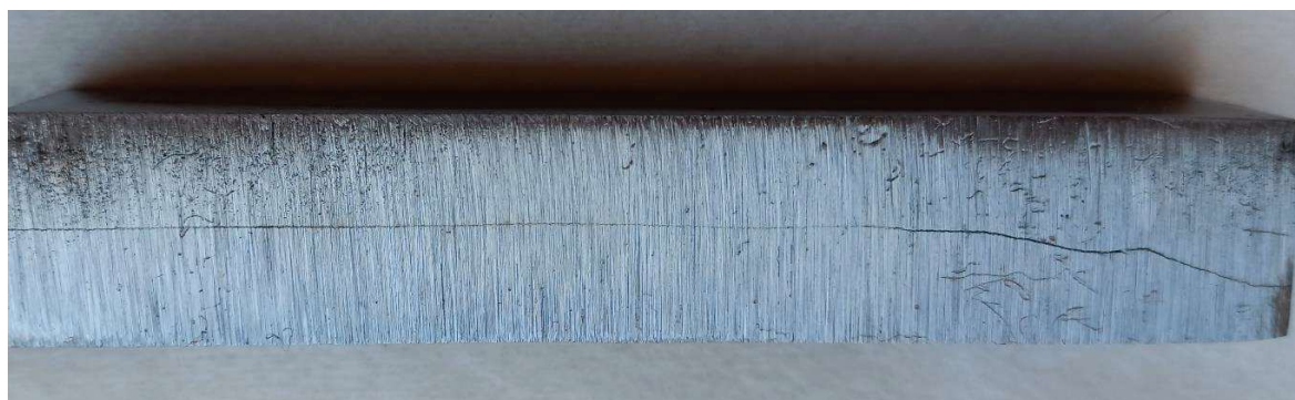
FIGURA 9. Imagem macroscópica da propagação da trinca (autoria própria).
