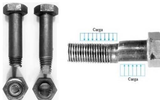
Figura 5 – Parafuso rompido por solicitação à tensão de tração e cisalhamento respectivamente.
