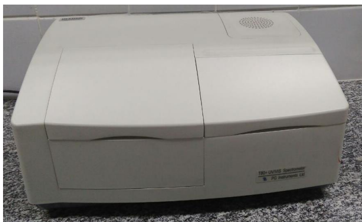
Figura 20 – Espectrofotômetro utilizado na medição da absorbância.
