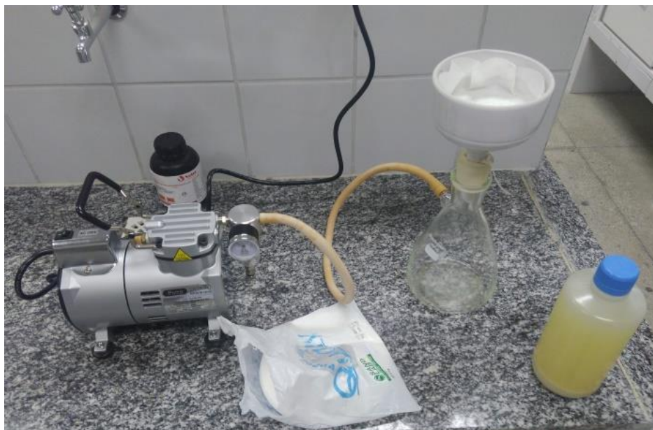
Figura 16 – Sistema de filtração a vácuo utilizado para retirada da levedura.
