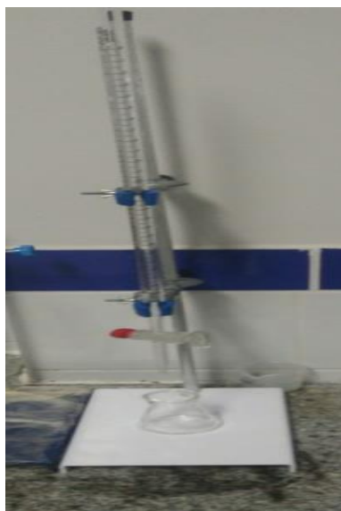
Figura 9 – Equipamentos utilizado para obtenção da acidez titulável.
