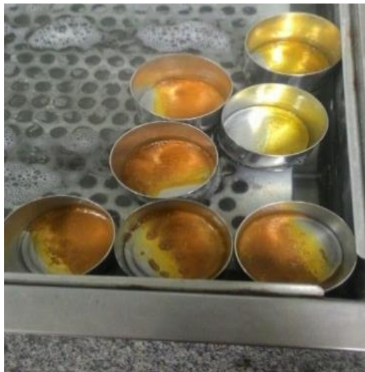
Figura 22 – Fermentado submetido à evaporação para a execução da análise do extrato seco.
