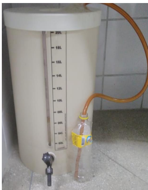
Figura 15 – Reator do tipo batelada utilizado para realização da fermentação alcoólica.
