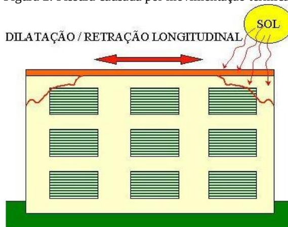
Figura 2: Fissura causada por movimentação térmica.
