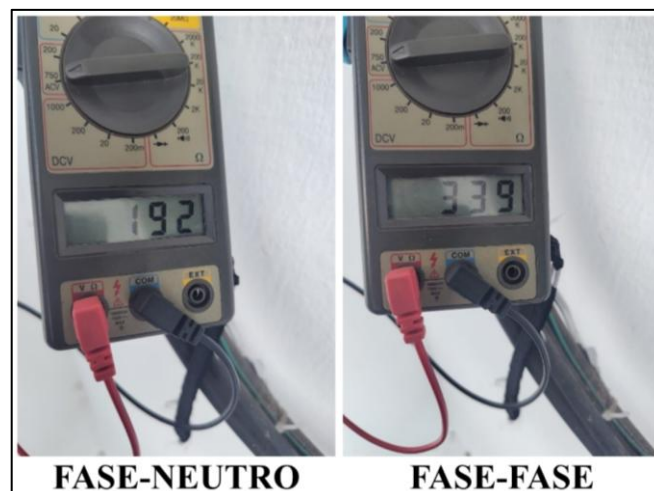
Figura 26 - Medição realizada na fábrica com multímetro de 16h do dia 25 de julho de 2025.
