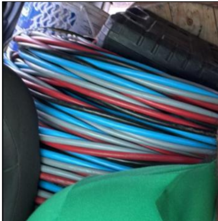
Figura 32 - Cabo de alumínio multiplexado com seção do condutor de 50mm 2 que passou a conectar o inversor ao padrão de entrada (cerca de 300m).
