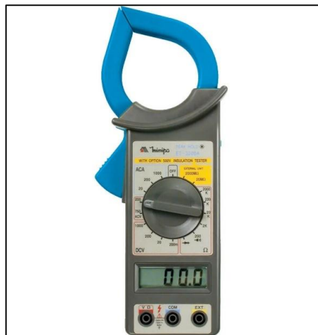
Figura 10 - Alicate amperímetro digital Minipa 1000A utilizado nas medições.
