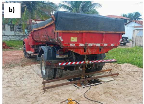
Figura 10 – Provas de carga em placa em execução: a) PCP1 (placa apoiada na superfície); b) PCP2 e PCP3 (placa apoiada a 2m de profundidade).
