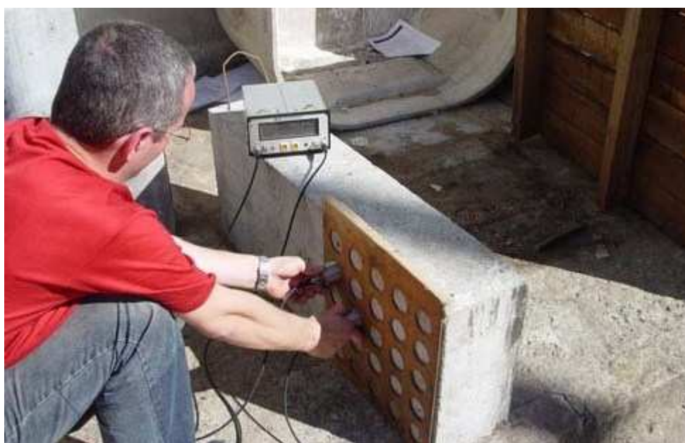
Figura 4: Ensaio de Velocidade de Pulso Ultrassônico.
