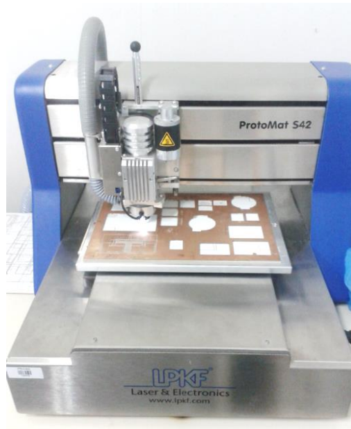
Figura 37 – Fresa de prototipagem utilizada na fabricação das antenas propostas.
