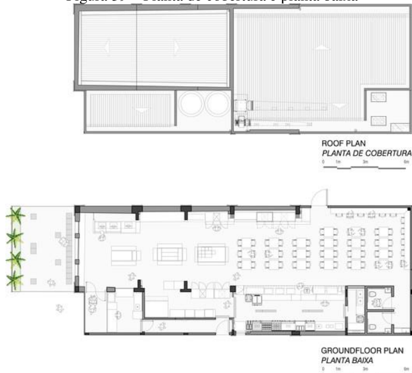
Figura 39 – Planta de cobertura e planta baixa
