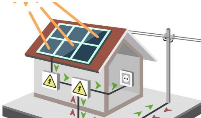
Figura 4 - Sistema Conectado à Rede
