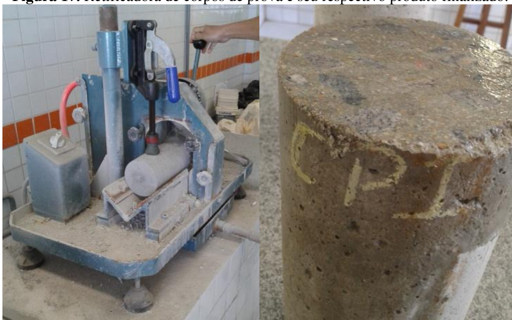
Figura 17. Retificadora de corpos de prova e seu respectivo produto finalizado.
