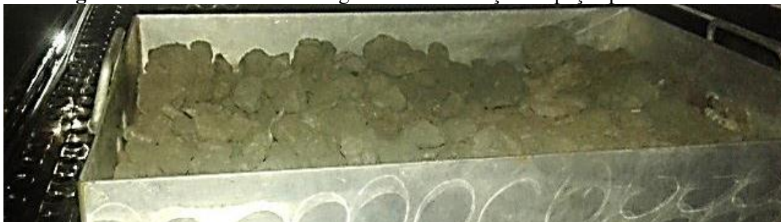
Figura 11. Amostra do resíduo gerado na fabricação de peças pré-moldadas.
