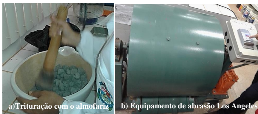
Figura 13. Equipamentos utilizados para ensaio de Análise Granulométrica
