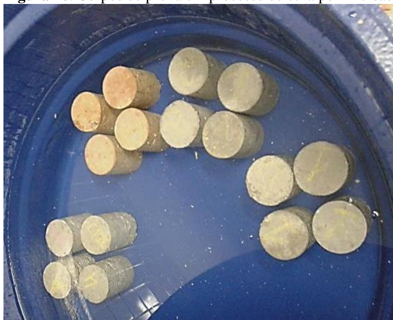
Figura 16. Corpos de prova em processo de cura por imersão.
