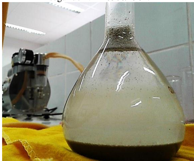
Figura 20. Amostra de pré-moldado sendo ensaiada para obtenção de massa específica segundo NBR 6508/1984.
