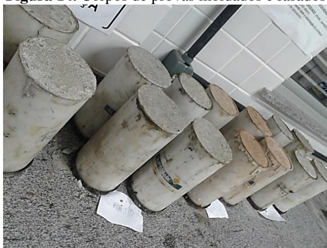
Figura 14. Corpos de provas moldados e rasados.
