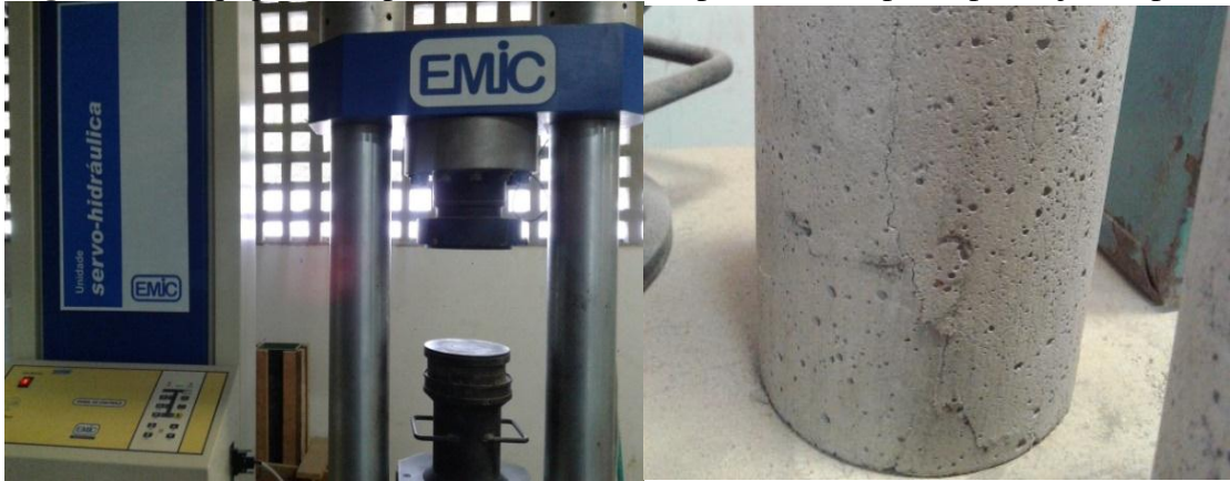
Figura 18. Equipamento para resistência à compressão e corpo de prova já rompido.
