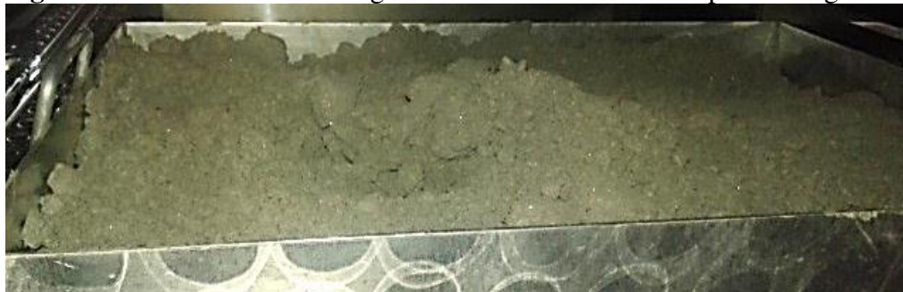
Figura 10. Amostra do resíduo gerado do beneficiamento de pedras de granito.
