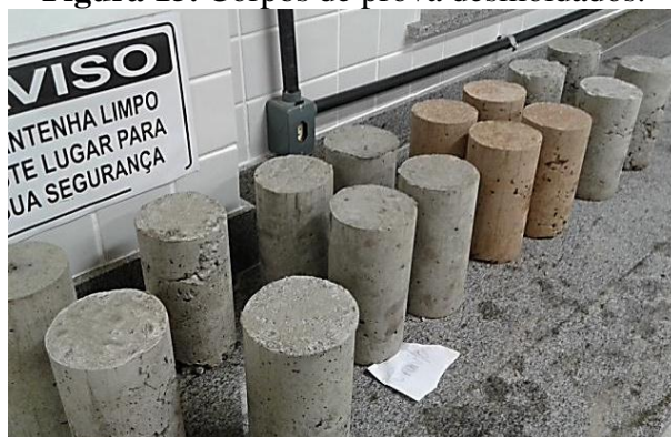
Figura 15. Corpos de prova desmoldados.
