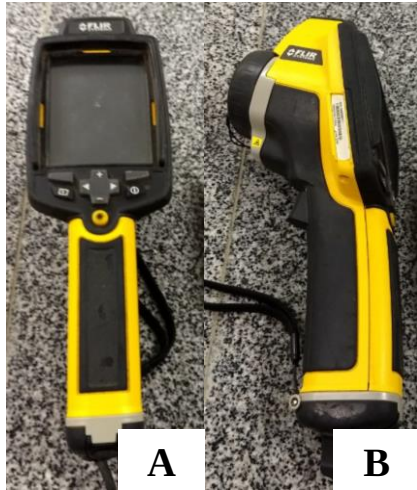
Figura 2. Câmera termográfica infravermelha vista frontal (A), vista lateral (B). Fonte: Arquivo pessoal.
