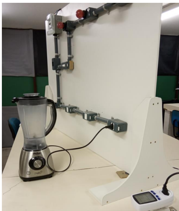
Figura 21 – Esquema da medição de potência e corrente pelo wattímetro
