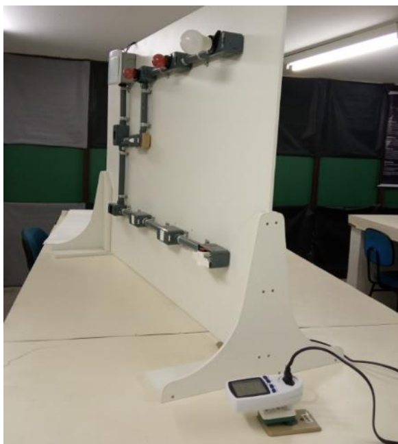
Figura 22 – Três lâmpadas ligadas em paralelo
