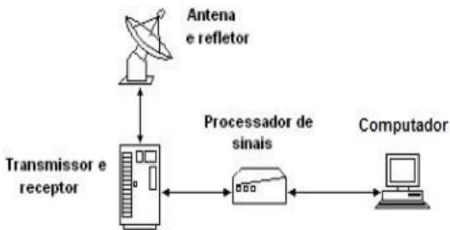
Figura 7: Esquematização de um radar meteorológico.
