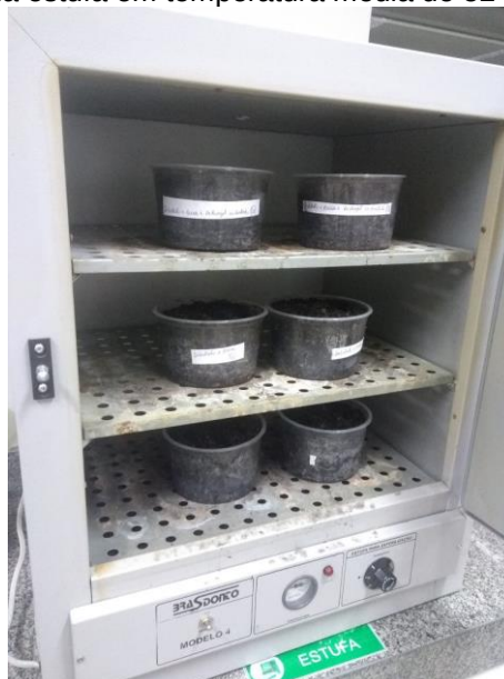
Figura 6 – Solo sem hidrogel, com hidrogel hidratado e com hidrogel não hidratado sob efeitos da estufa em temperatura média de 52°C
