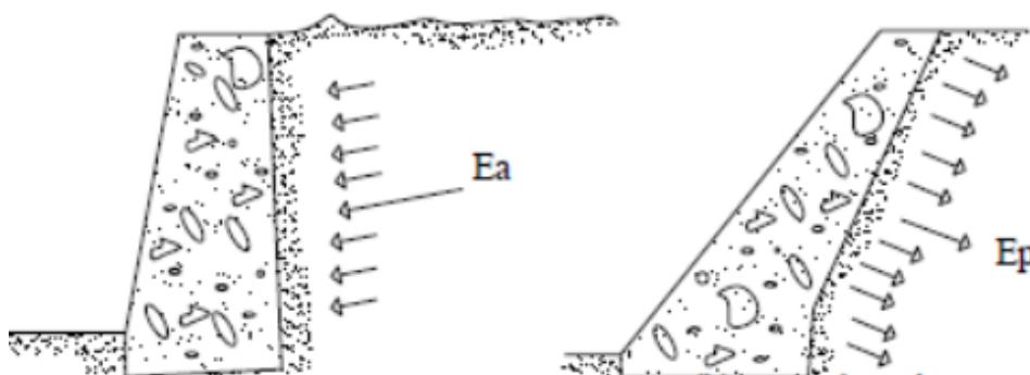
Figura 8: Tipos de empuxo de terra
