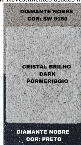
Figura 38: Revestimentos usados nas fachadas.
