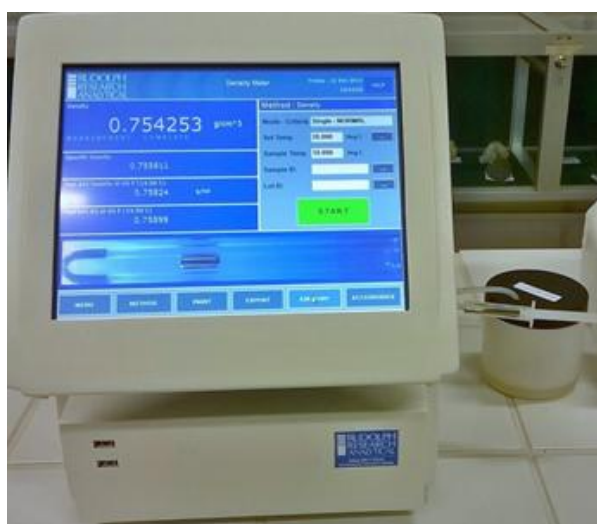
Figura 3 – Resultado do ensaio de massa específica de amostra de gasolina tipo C coletada no Município de Patu-RN.
