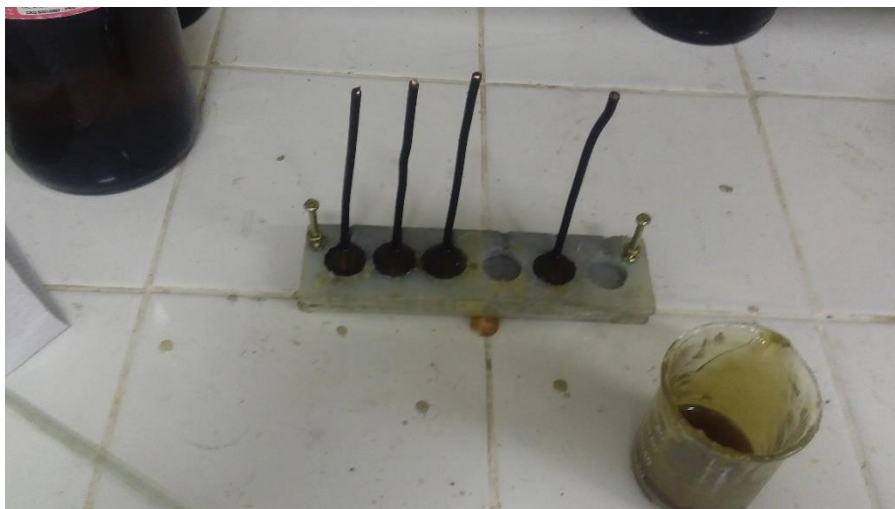
Figura 2. Matriz utilizada na confecção dos eletrodos.
