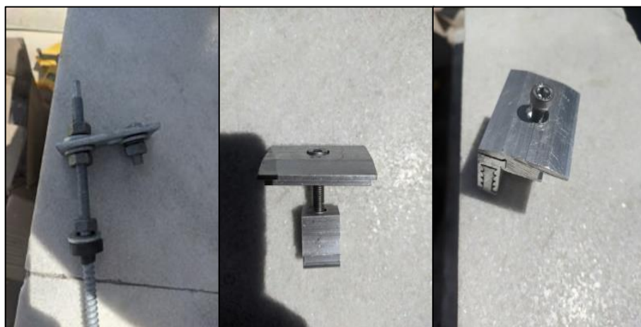
Figura 13: Estrutura de sustentação para os módulos.
